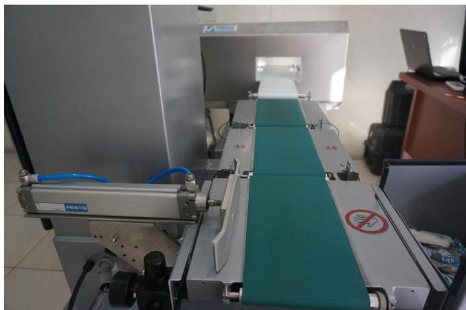
**Figura 2. 13** Fotografía bandas transportadoras. Bandas transportadoras usadas en el prototipo.
