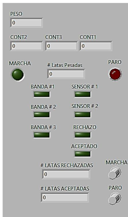
**Figura 3. 36** Front Panel - Sistema de Monitoreo de Balanza Dinámica.
