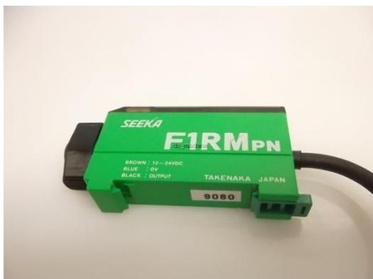
**Figura 3. 18** Sensor de fibra Óptica. Sensor utilizado para ubicación del producto dentro de la banda de pesaje.
