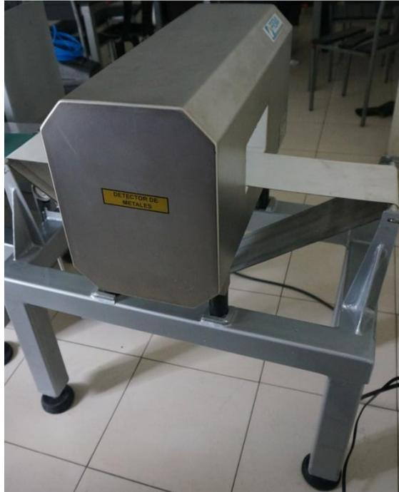
**Figura 3. 4** Bobina de detector de metales. Fotografía del detector de metales el cual detecta el paso de material ferromagnético que lleve la banda transportadora.
