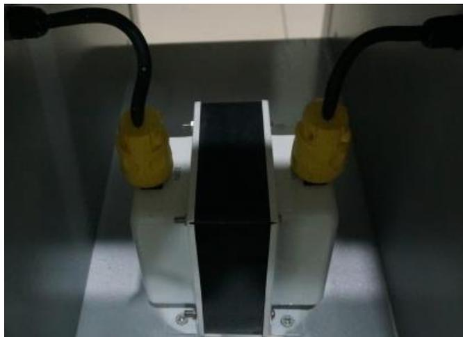
**Figura 3. 7** Transformador de corriente. Transformador de 1500Watts utilizado para la alimentación requerida por el detector de metales, entrada 115V y salida 230V.
