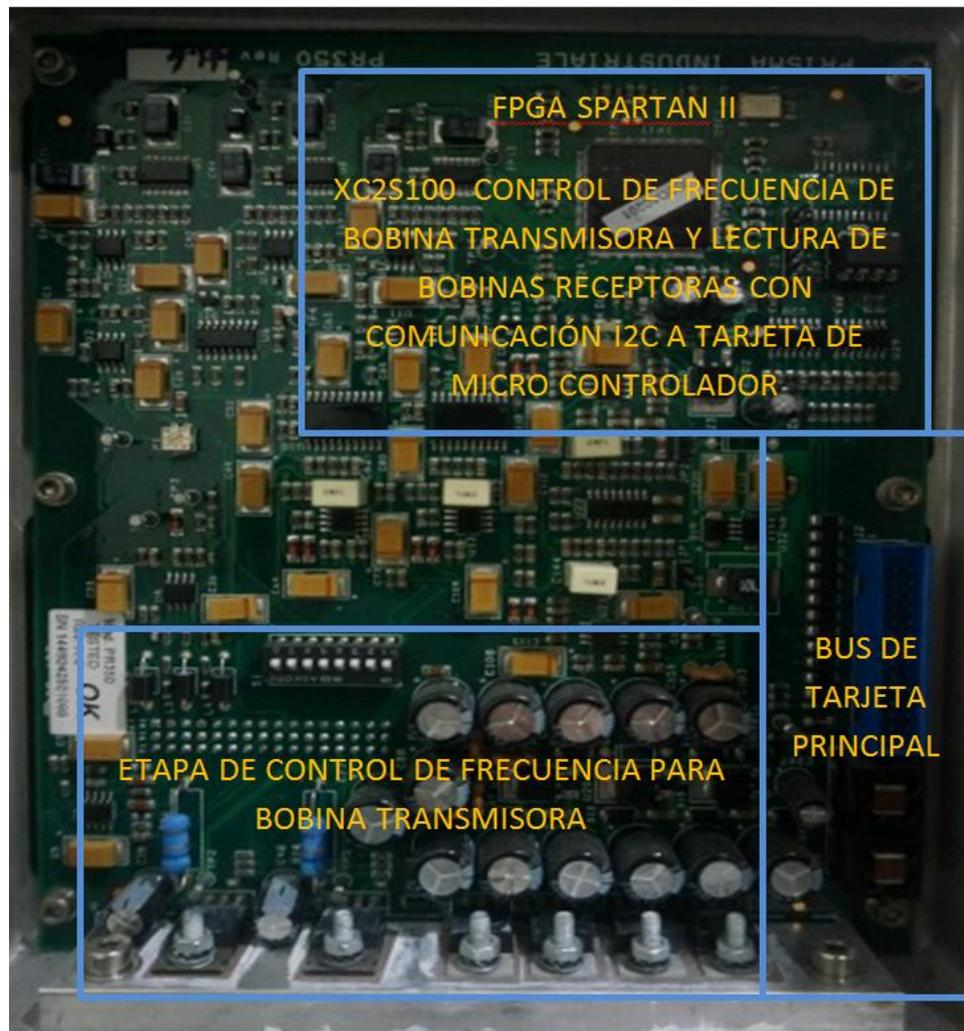
**Figura 3. 10** Tarjeta de control de bobinas. Se puede apreciar gran cantidad de electrónica con elementos de montaje superficial esta tarjeta controla la frecuencia en la bobina transmisora y la lectura de las bobinas receptoras para luego enviarla por I2C a la tarjeta del microcontrolador la señal de detección de metales.
