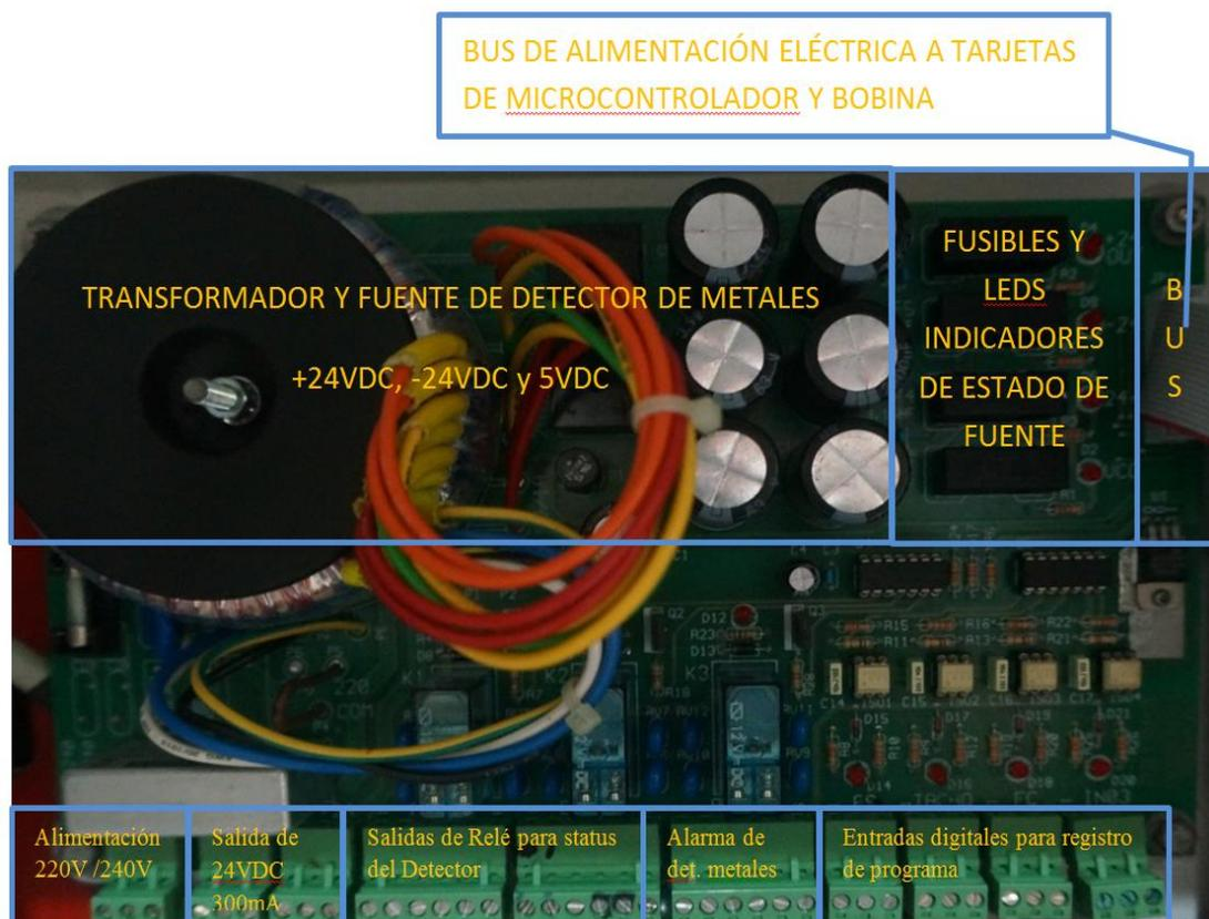
**Figura 3. 8** Tarjeta fuente y relés. Se puede apreciar en bloques la distribución, las salidas y entradas del detector de metales marca PRISMA modelo PR08.
