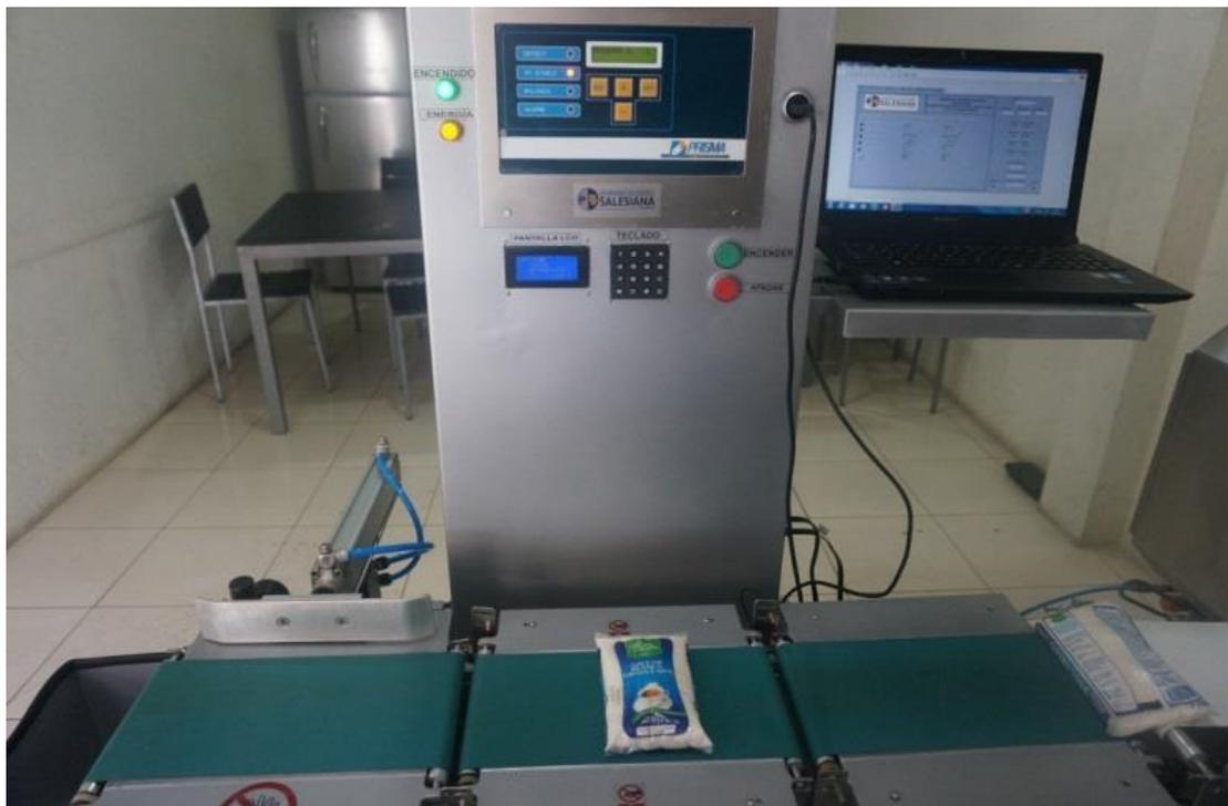
**Figura 1. 1** Foto de chequeo de fundas de azúcar en el prototipo.
