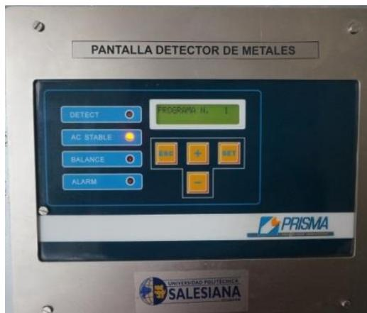
**Figura 3. 5** Pantalla del detector de metales. En esta pantalla se programa la sensibilidad del detector y la salida de alarma, también trae LEDs indicadores del status del equipo.
