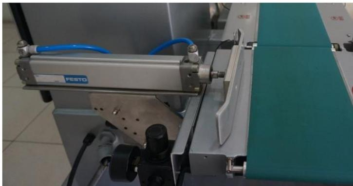
**Figura 2. 16** Actuador neumático de doble efecto. Cilindro plano de doble efecto vástago simple de 32mm de diámetro del embolo y 200mm de carrera usado para rechazo de productos en la cuarta banda para el prototipo de balanza dinámica
