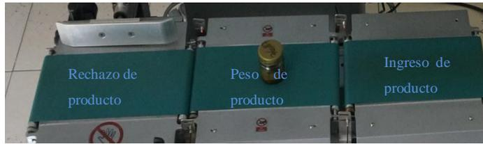
**Figura 3. 11** Secuencias físicas para verificación de peso. En la fotografía se puede apreciar cada una de las secuencias que tiene el prototipo para su verificación del peso, en caso de que este se encuentre fuera de la tolerancia permitida en la banda de rechazo actúa un cilindro neumático para botar el producto fuera de la misma. Si el peso está dentro de su tolerancia no se ejecuta el rechazo.
