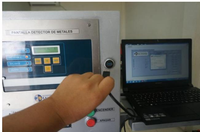
**Figura 2. 24** Puerto USB del prototipo. Puerto USB para comunicación del prototipo de balanza dinámica a la computadora.
