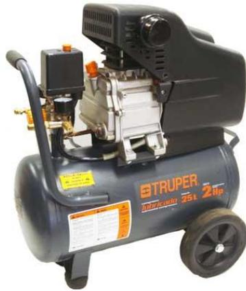
**Figura 2. 15** Compresor y depósito de aire comprimido. Utilizado para el funcionamiento del actuador neumático del prototipo de balanza.
