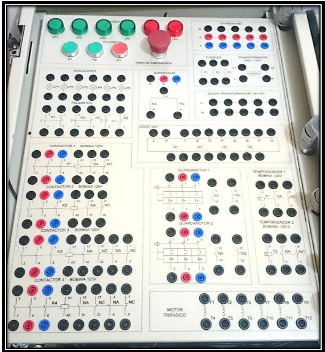
Figura 3.13: Montaje de elementos panel didáctico.
