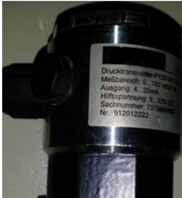
Figura 41. Transmisor de Nivel.
