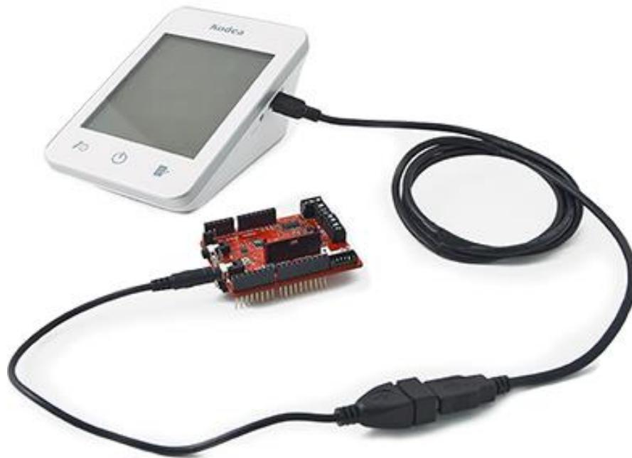
**Figura 3-24** Conexión del sensor de presión arterial a la plataforma de salud. Conexión para descarga de datos del esfigmomanómetro. Fuente (Hacks, s.f.)
