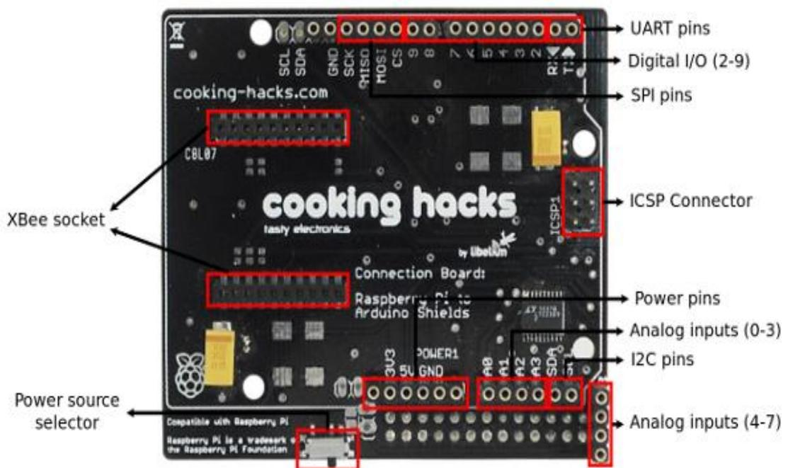
**Figura 3-10** Esquema Puente de conexión. Detalle de cada pin de conexión de la parte frontal. Fuente (Hacks, s.f.)
