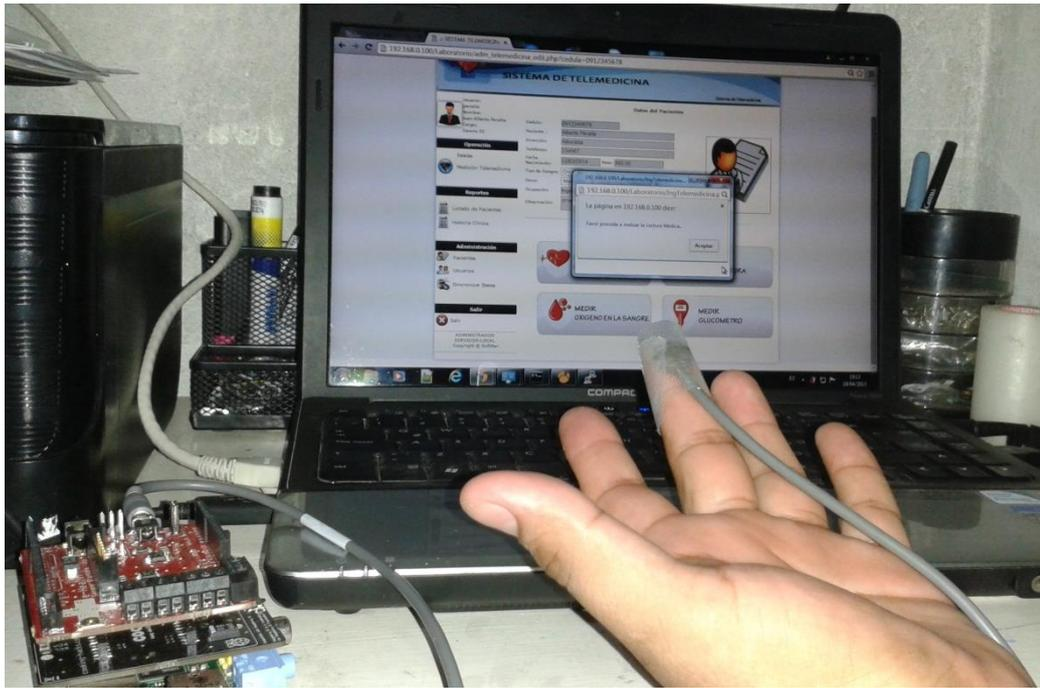
**Figura 6-4** Prueba de medición de temperatura a la aplicación web. Conexión del sensor al paciente a realizar la toma médica.
