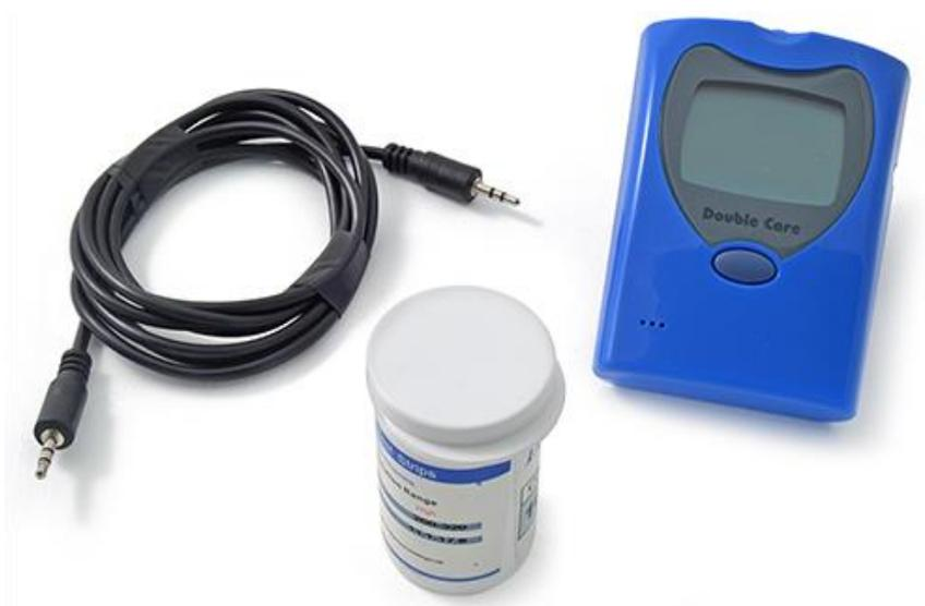
**Figura 3-17** Sensor glucómetro. Kit de trabajo para la de medición de la glucosa. Fuente (Hacks, s.f.)
