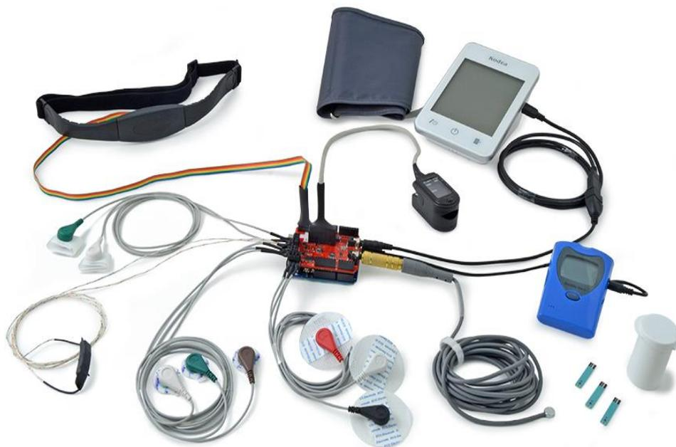
**Figura 3-16** Kit completo de sensores médicos para plataforma de salud. Sensores médicos conectados al dispositivo de plataforma de salud controlado por Raspberry PI. Fuente (Hacks, s.f.)
