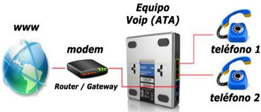
**Figura 2-6** Estructura de la tecnología VOIP. Diagrama esquemático para la conexión VOIP. Fuente (VOIP, s.f.)
