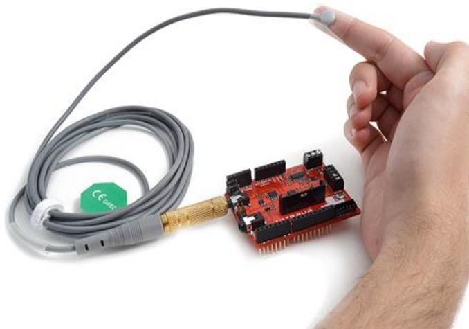
**Figura 3-26** Conexión del sensor de temperatura a una plataforma de salud. Toma de medida conectado a la plataforma de salud. Fuente (Hacks, s.f.)
