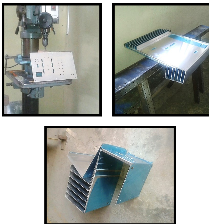
Figura 3.1.3 Construcción de piezas del módulo didáctico. Puede apreciarse el proceso de construcción del módulo, el cual fue elaborado en partes que luego fueron ensambladas para formar la estructura final.
