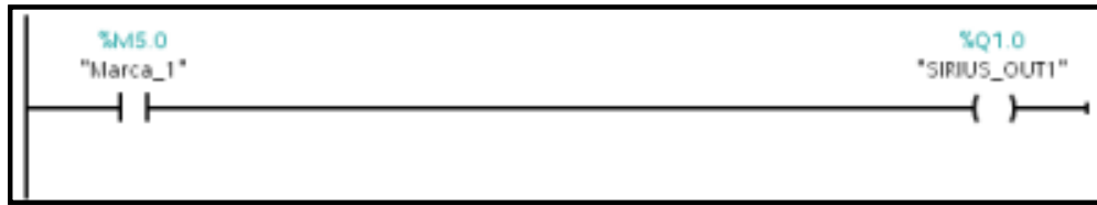
Figura 4.3.2 Activación de la salida del arrancador
