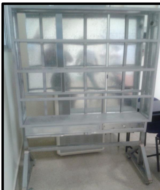
Figura 3.3 Cuerpo principal del Módulo didáctico. Este cuerpo del Módulo no fue aceptado en primera instancia, debido a que no cumplió la condición de poder colocar y retirar las láminas fácilmente.
