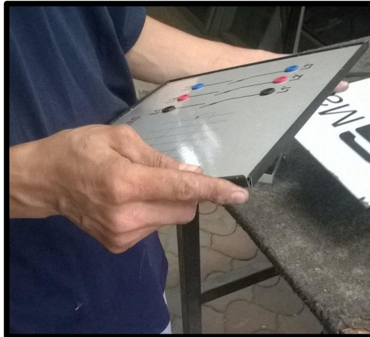
Figura 3.23 Pegado de marcos de aluminio a láminas de Alucobond. Se utilizó silicón industrial para mayor fijación.
