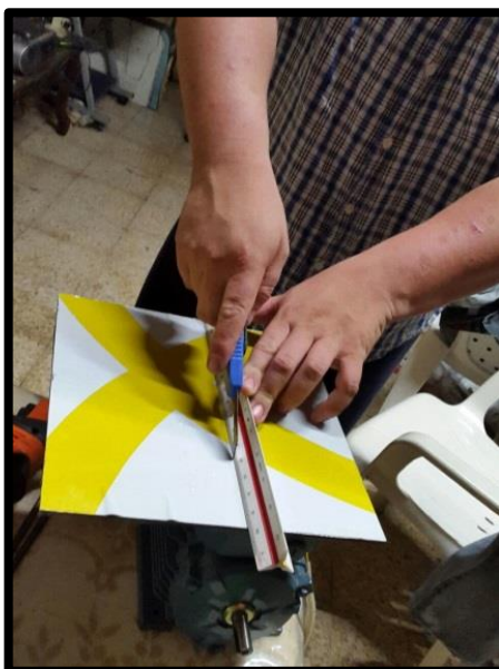
Figura 3.12 Corte de Alucobond con estilete de hoja gruesa.
