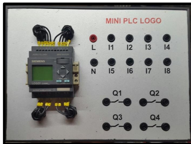
Figura 3.34 Lámina de Mini PLC LOGO. Solo se puede programar manualmente. Tamaño 25 de altura x 40 de ancho
