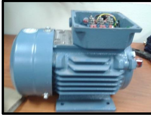
Figura 2.1 Motor trifásico 0,5HP. Internamente contiene 12 terminales.
