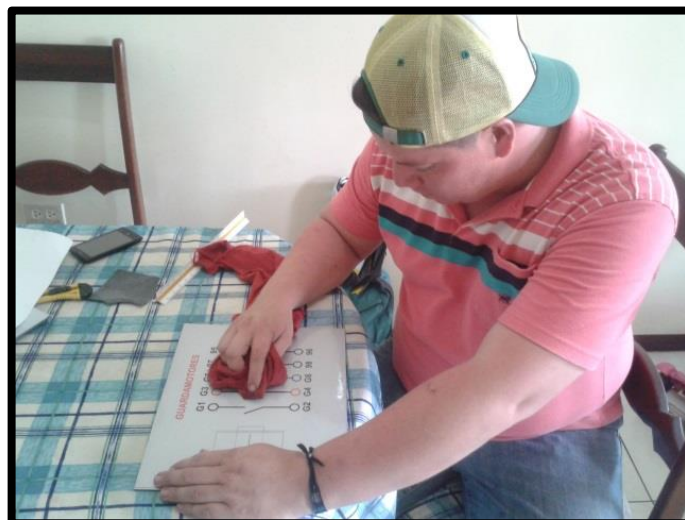
Figura 3.14 Pegado de vinil en el Alucobond. Se utilizó agua mezclado con jabón líquido para dar tiempo de colocar antes que se quede fijo el vinil en la lámina.
