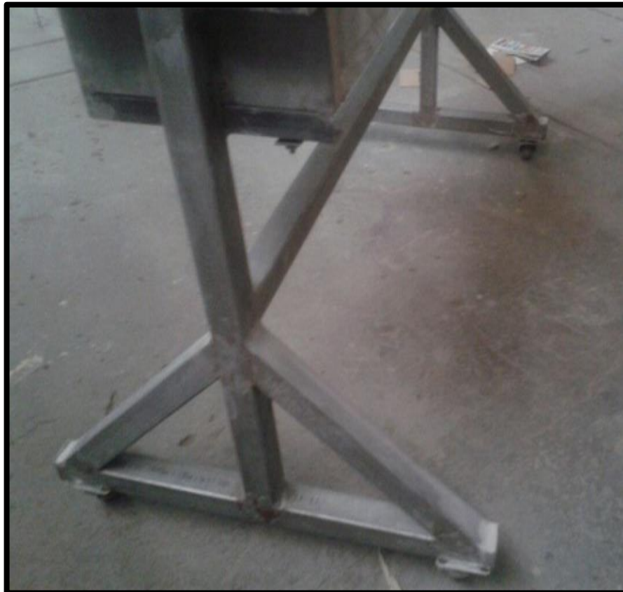
Figura 3.2 Estructura base del módulo didáctico. La implementación de ruedas ayuda a la movilidad del tablero.
