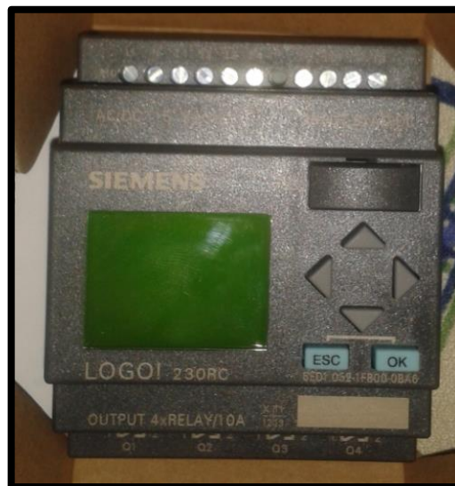
Figura 2.9 Mini PLC LOGO. Modelo 230RC de 8 entradas y 4 salidas, alimentación 220V
