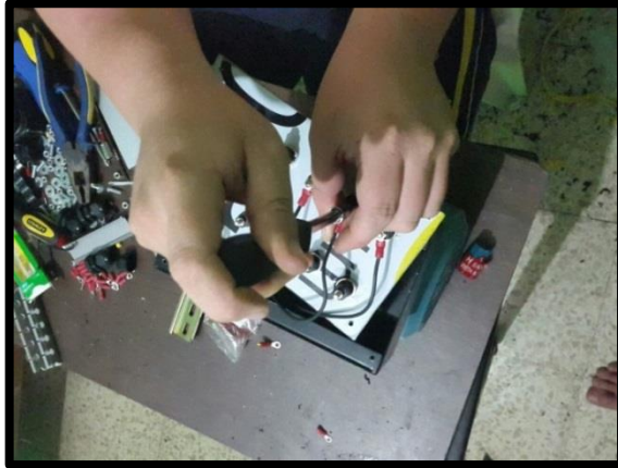
Figura 3.21 Ajuste de terminales de ojo a los jacks. Evitando la soldadura de estaño.
