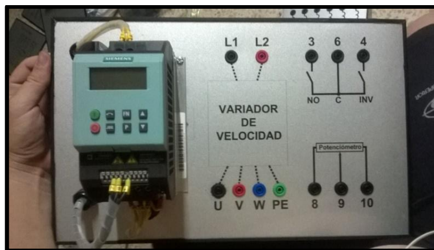
Figura 3.36 Lámina de Variador de frecuencia. Tamaño 25de altura x 35 de ancho.
