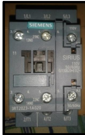
Figura 2.7 Contactor trifásico Siemens. Modelo SIRIUS 3RT2023.
