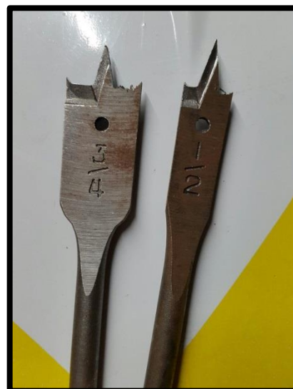
Figura 3.18 Brocas planas. Diámetro de 1/2 y 3/4 pulgadas.
