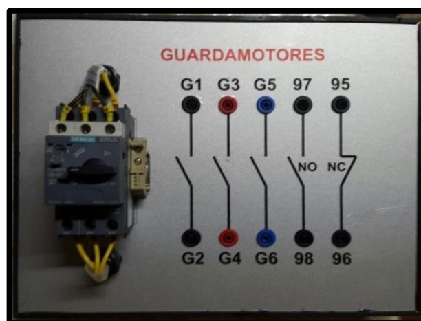
Figura 3.29 Lamina de Guardamotor Siemens familia SIRIUS. Tamaño 25 de altura x 27 de ancho.
