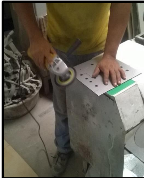
Figura 3.19 Pulido de Láminas. Nótese como se retira las alimañas de aluminio.
