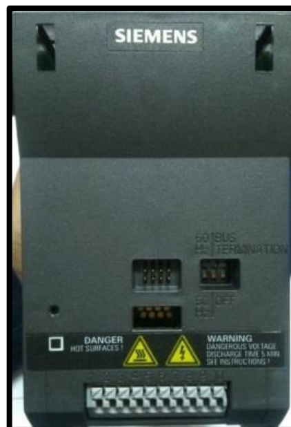
Figura 2.6 Variador de frecuencia Siemens. Modelo SINAMICS G110 que controla dos fases, sin BOP (Basic Operator Panel).
