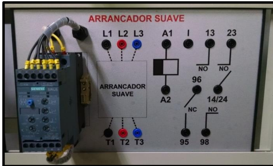
Figura 3.35 Lámina de Arrancador suave. Tamaño 25 de altura x 35 de ancho.
