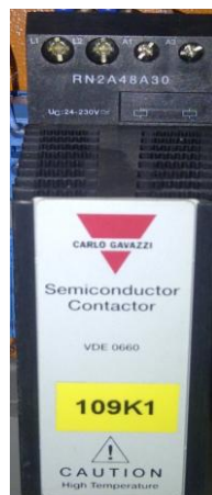
Figura 45: Relé de estado sólido con doble bobina y doble salida de conmutación con disipador marca Carlo Gavazzi. Fuente: Carlo Gavazzi (2014)
