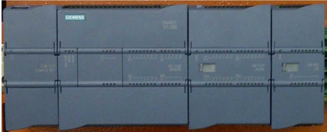
Figura 46: CPU y módulo de entradas y salidas marca Siemens modelo 1214C DC/DC/DC.
