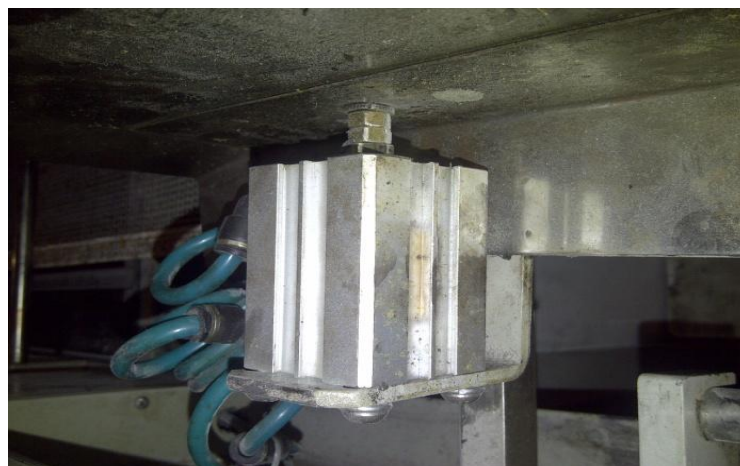
Figura 34: Pistones emparejador Fuente: El Telégrafo (2014)
