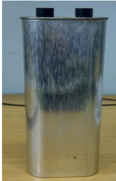
Figura 42: Capacitores de Potencia Fuente: El Telégrafo (2014)
