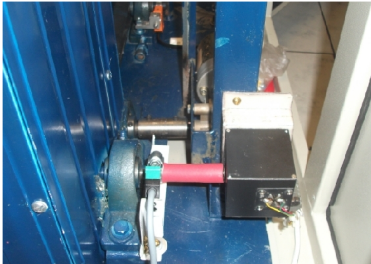
Figura 4.7 Generador de pulso para medición de velocidad
