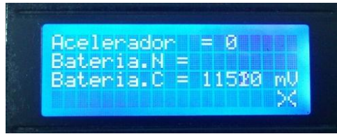
Figura A20. Mensaje de funcionamiento de control remoto. Al estar trabajando el sistema se mostrará en el display los datos de batería y los datos de aceleración
