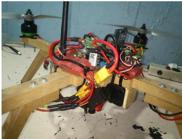
Figura A.11. Montaje de placa distribuidora de energía. Vista lateral de la placa que distribuye la energía a los cuatro variadores para alimentar al sistema.
