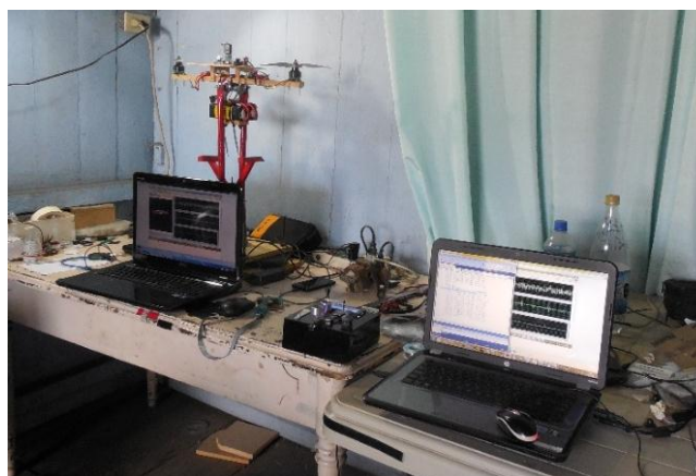
Figura A15. Captura de datos con Labview. Para análisis del funcionamiento del sistema se procedió a la captura de datos con Labview.
