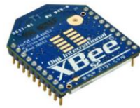
Figura 2.6. XBee. Módulo de transmisión inalámbrico XBEE. Fuente Digi International Inc. (2014).
