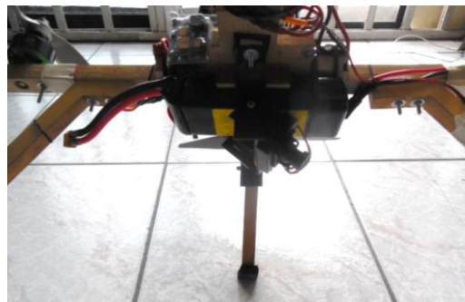
Figura 3.17. Cámara a 135°. Posición de cámara a un ángulo de 135° con respecto a la estructura.
