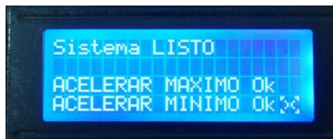
Figura A19. Mensaje de sistema listo. Al estar en preparado el sistema mostrará en el display la frase “Sistema LISTO”
