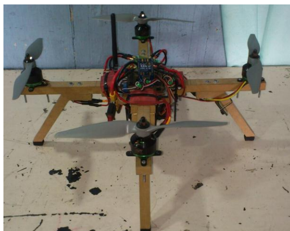
Figura A.12. Estructura final con elementos acoplados. Vista superior de todos los elementos instalados en la estructura final.
