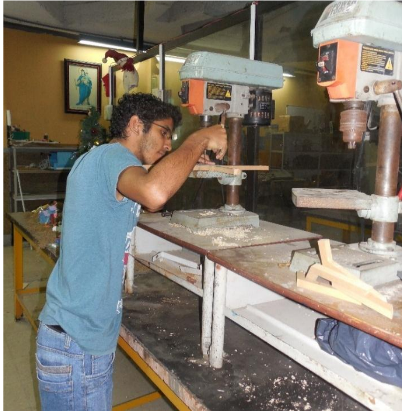
Figura A.3. Perforación de estructura. Realización de orificios a la estructura final para montaje de piezas.
