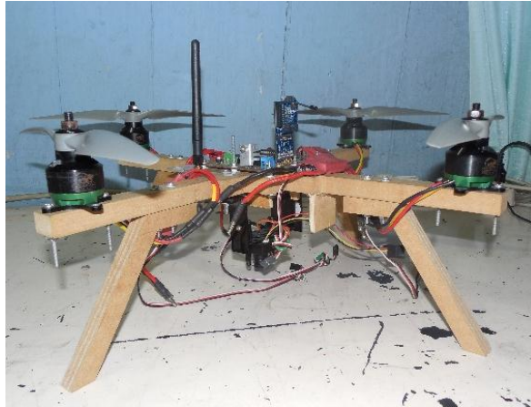
Figura A.10. Montaje de cámara, placa controladora y transmisor de video a la estructura. Vista lateral de elementos incorporado a la estructura final.
