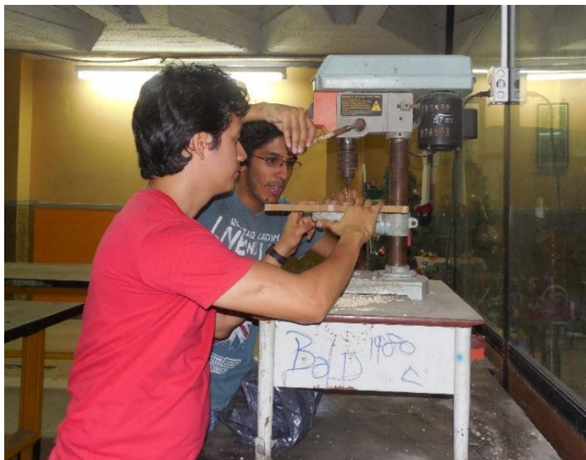
Figura A.4. Perforación de estructura. Realización de orificios a la estructura final para montaje de piezas.
