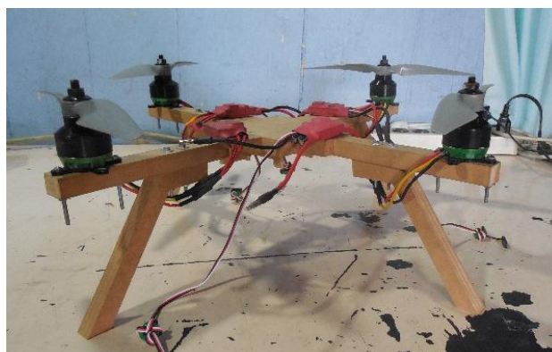
Figura A.9. Montaje de los actuadores a la estructura. Vista lateral de elementos incorporado a la estructura final.
