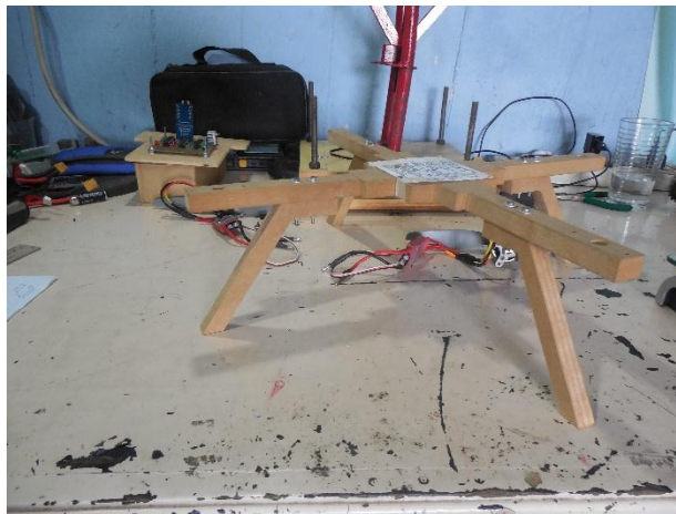
Figura A.8. Montaje de los soportes a la estructura. Vista lateral del acople de los soportes a la estructura final.
