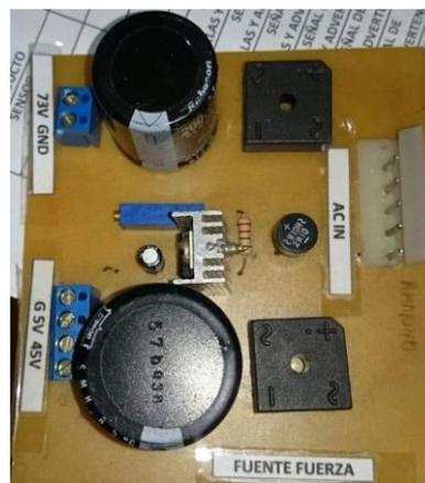
**Figura 3.11** Fuente de poder sección fuerza para pruebas. **Por:** Autoría propia, (2014-2015).
