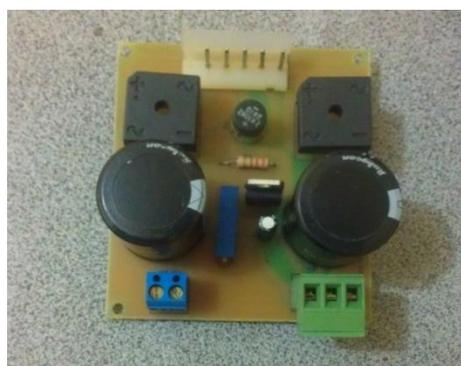
**Figura 3.12** Fuente de poder final del proyecto para fuerza. **Por:** Smelektroniks, (2015).
