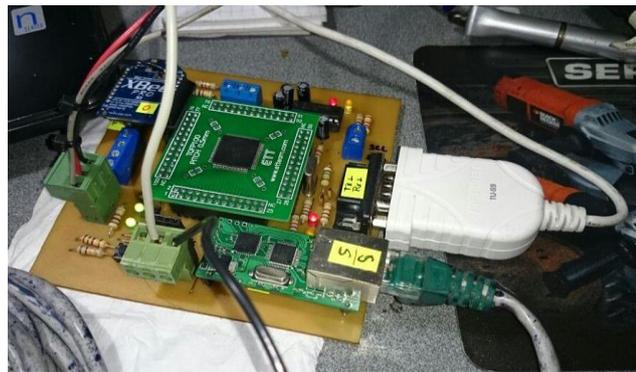
**Figura 3.20** Tarjeta central de comunicaciones para pruebas y mediciones. **Por:** Autoría propia, (2014).
