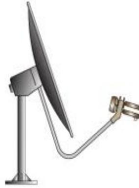
**Figura 2.25** Antena parabólica offset. **Por:** Martin & Alba, (2012), Infraestructuras comunes de telecomunicación en viviendas y edificios.
