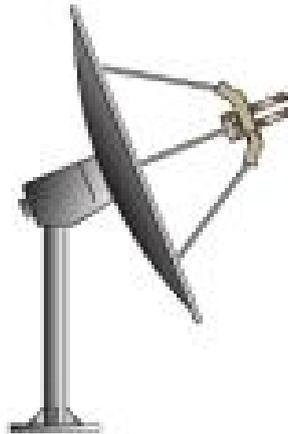
**Figura 2.24** Antena parabólica de foco primario. **Por:** Martín & Alba, (2012), Infraestructuras comunes de telecomunicación en viviendas y edificios.
