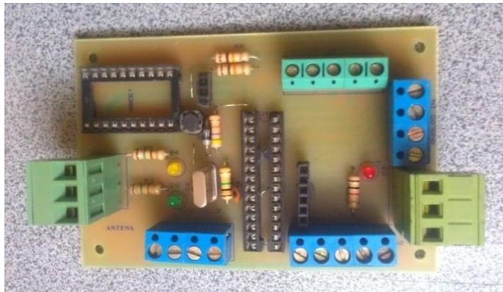
**Figura 3.31** Tarjeta final para el control de la antena de recepción satelital. **Por:** Smelektroniks, (2015).
