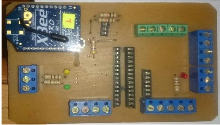
**Figura 3.30** Tarjeta para pruebas de control de la antena de recepción satelital. **Por:** Autoría propia, (2014).
