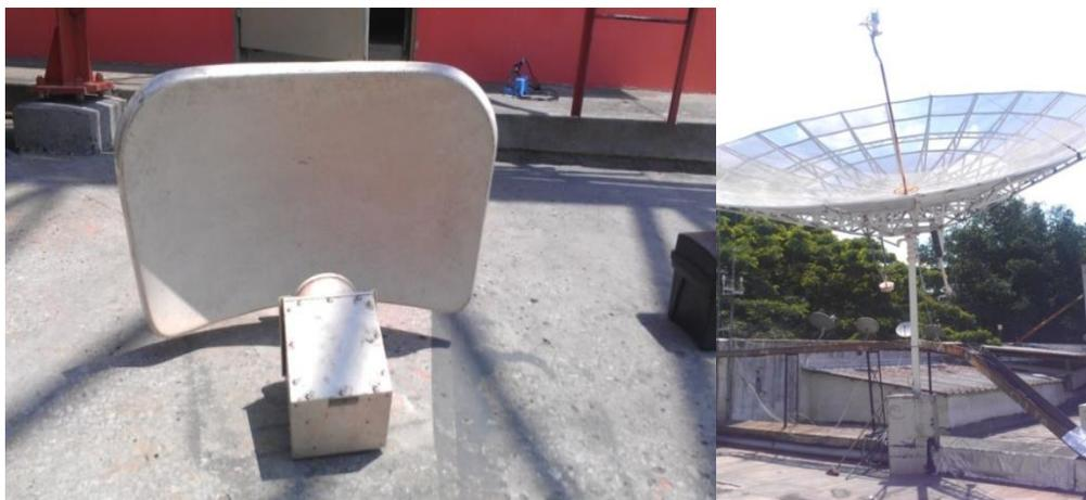
**Figura 2.32** Antena de recepción satelital y rotor. **Por:** Andrews & Microwave, (2015).
