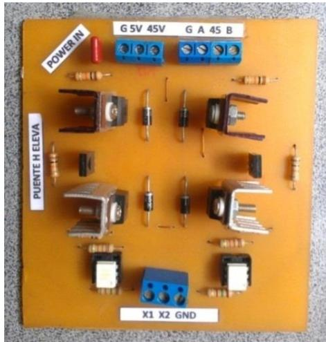
**Figura 4.9** Diseño para pruebas y mediciones de tarjetas puente H. **Por:** Autoría propia, (2014).
