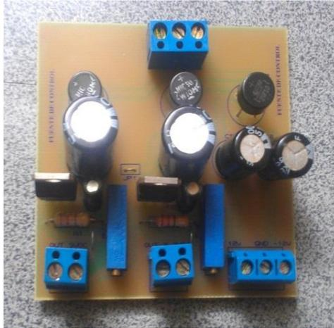
**Figura 3.8** Fuente de sección control. Por: Smelektroniks, (2015).
