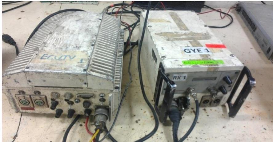
**Figura 4.12** Receptor y transmisor de microondas. **Por:** Microwave, (2000).
