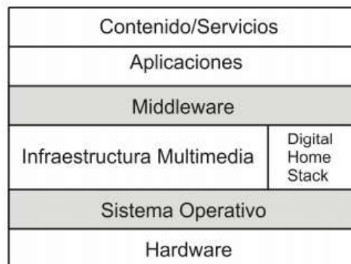
Figura 2.12 Arquitectura General de un Set-Top-Box
