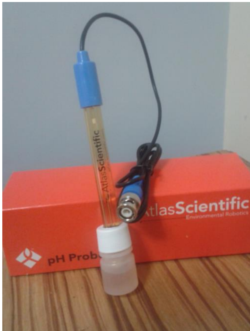
Figura 21. Foto de sonda de pH (Potencia de Hidrógeno) marca Atlas Scientific.
