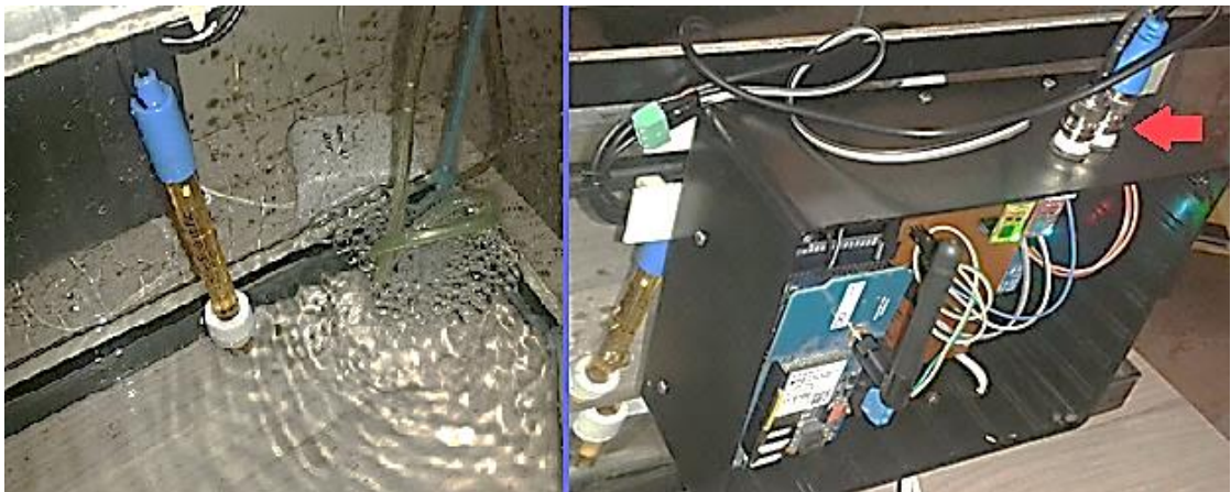
Figura 40. Sensor de pH conectado a la placa PCB del módulo de sensores.
