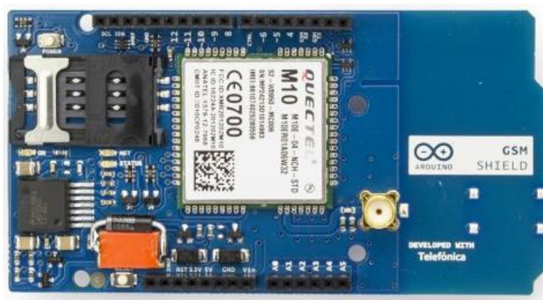
Figura 13. Vista Superior del Shield Arduino GSM.
