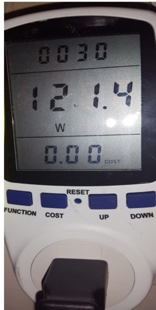
Gráfico 16. Medición de Watts en Servidor controlador de dominio.
