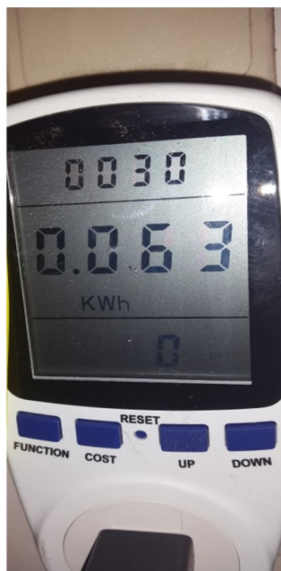
Gráfico 15. Medición de KWh en Servidor controlador de dominio.
