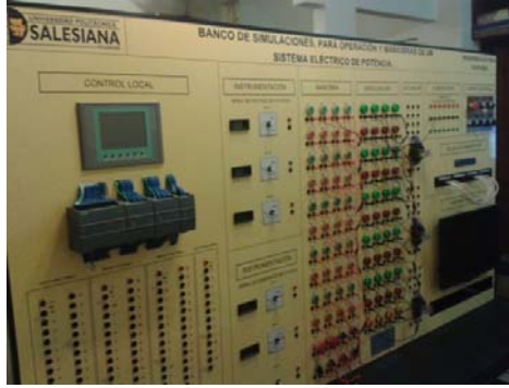
Figura 89 Banco de Simulaciones de un Sistema Eléctrico de Potencia
