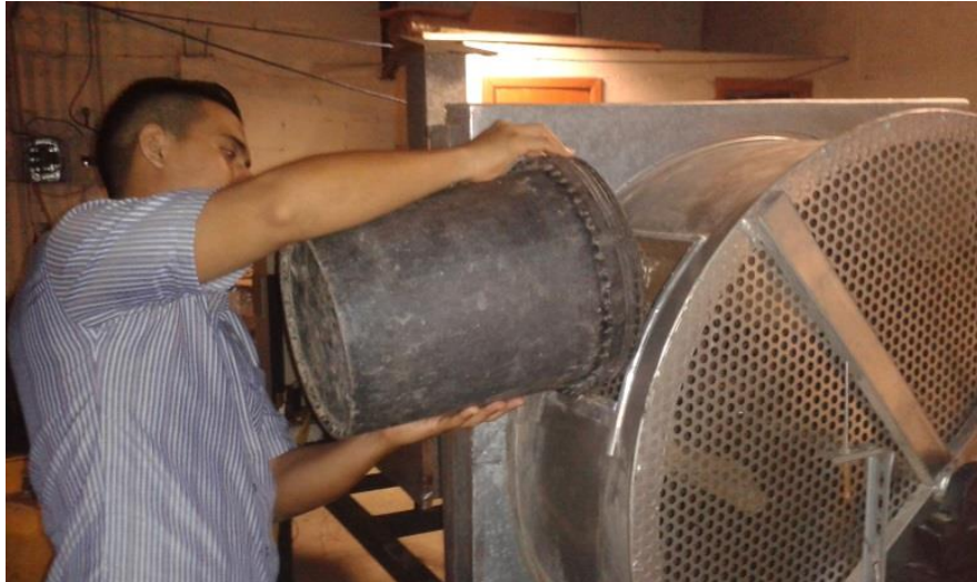
Figura 5.10. Ingreso del cacao a la cámara de secado. Fuente: Los autores.
