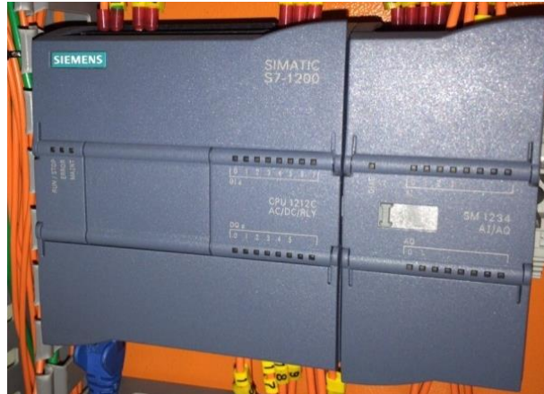
Figura 4.1. PLC S7-1200 Fuente: Los Autores
