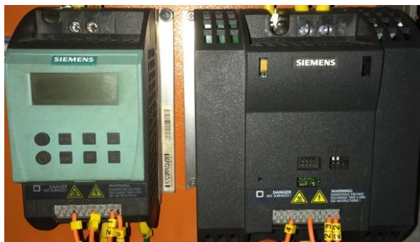
Figura. 3.20. Variador de Frecuencia. Fuente: Los autores
