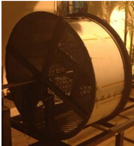
Figura 3.14. Cámara de secado. Fuente: Los autores
