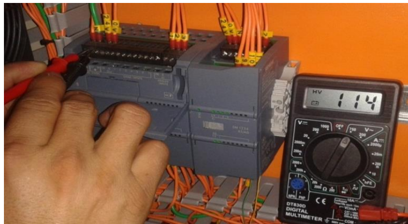
Figura 5.9. Voltaje de alimentación del PLC S7-1200 Fuente: Los autores.
