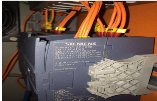
Figura 3.22. Característica del PLC s7-1200 Fuente: Los Autores
