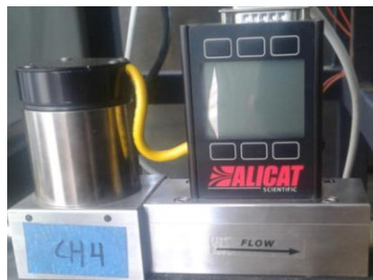
Figura 3.23. Controlador de Flujo Fuente: Los Autores
