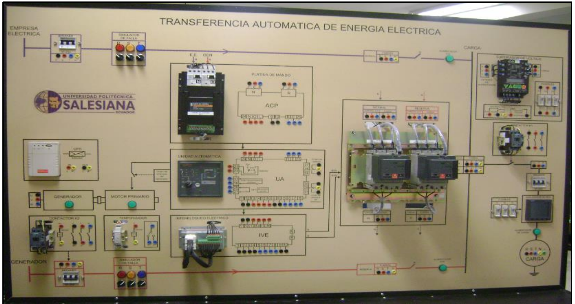
Figura 4 Módulo didáctico de transferencia de energía eléctrica
